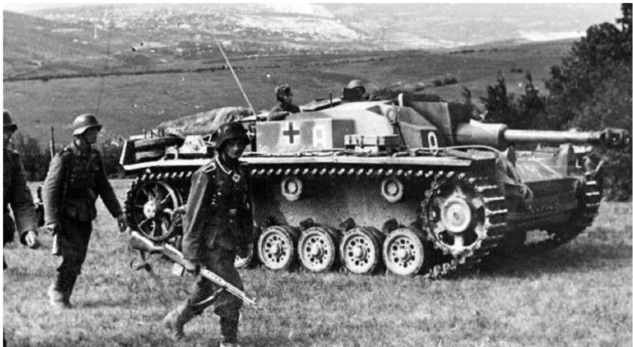
Эта САУ или самоходно-артиллерийская установка оказалась эффективней многих танков, по отчетам Вермахта, Stug III подбила более 20 000 танков. Stug III создан на базе танка PzKpfw III.
